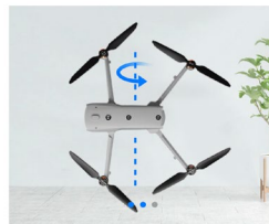
第三步 如圖所示，將飛機側向旋轉 360 度
